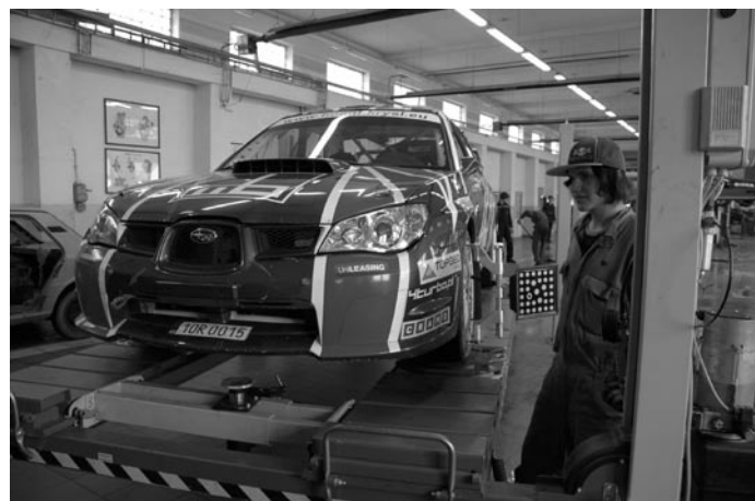
Zařízení pro prostorové 3D měření geometrie osobních a dodávkových automobilů.
