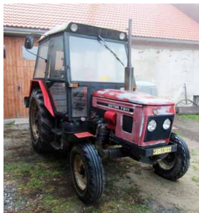
Traktor ZETOR 7011 po opravě zadních blatníků a plechařiny
