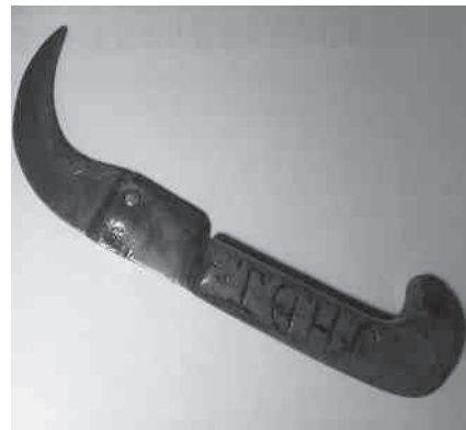
Nůž na seřezávání vrbového proutí
